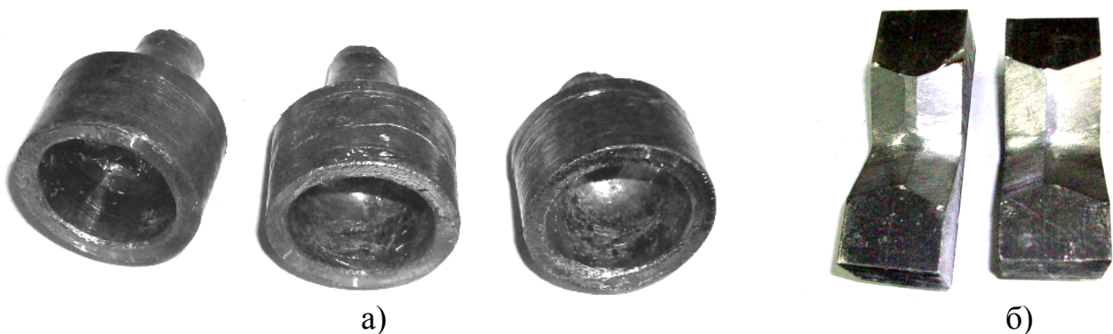
Рисунок 3 – Форма отриманих заготовок (а) і вирізні бойки зі скосами (б)
